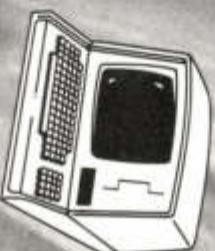
ZENITH 128 sous CP/M Micro-processeur 286, mémoire 48 à 64 Ko, écran 80 colonnes, graphique haute résolution 320 x 256, disquettes 137 Ko, 480 Ko ou 1.2 Mo, écran dur 5 Mo.
